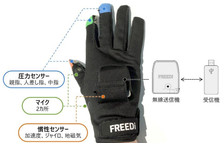
日立開発のセンサー付きグローブの詳細
